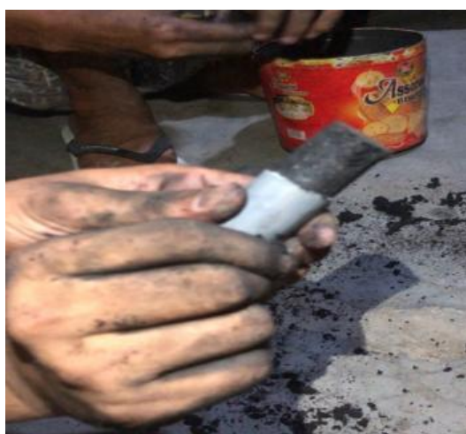
Gambar 6. Proses pencetakan briket
