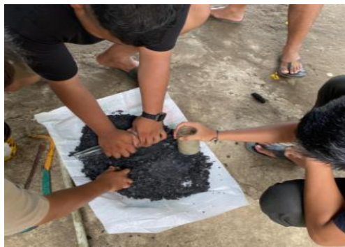
Gambar 2. Proses penghancuran tempurung kelapa yang sudah dibakar
