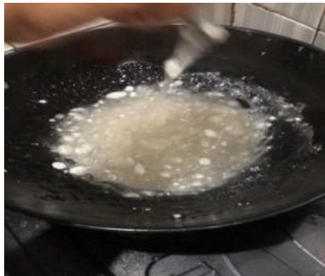
Gambar 4. Proses memasak tepung kanji/tapioka sebagai bahan perekat
