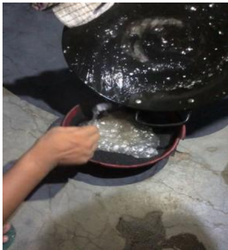
Gambar 5. Proses pencampuran bahan perekat dengan arang yang sudah halus
